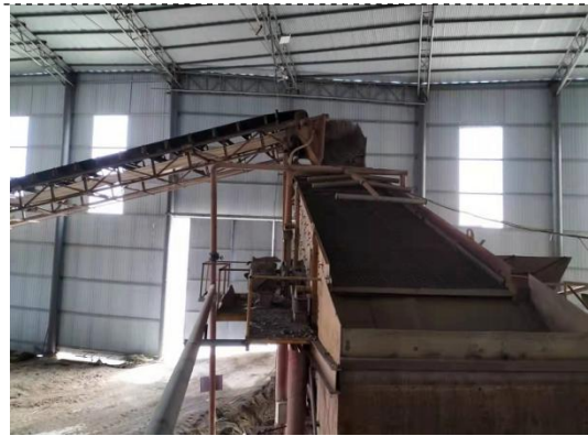
振动筛湿法作业洒水系统
